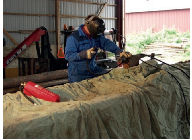
▲ Hitsaaminen on turvallista, kun paloherkät materiaalit suojataan märällä, palamattomalla pressulla. Lähellä pitää olla kaksi isoa alkusammutinta.
