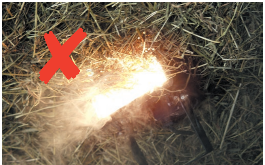
▼ Kuuma halogeenilamppu sytyttää hetkessä lampun päälle putoavan paloherkän materiaalin.
