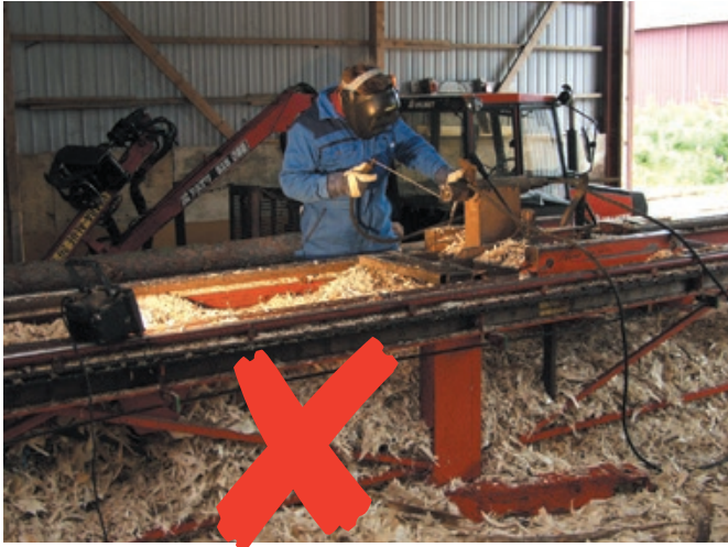
▲ Hitsaaminen paloherkän materiaalin lähellä, saati päällä on jyrkästi tulityösääntöjen vastaista. Paloriski on tässä todella suuri.
