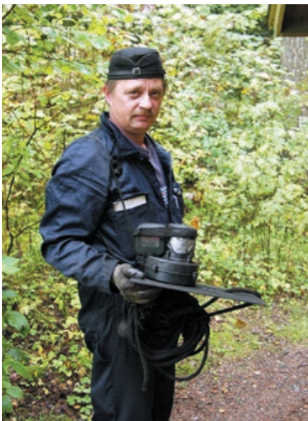
▲ Piippumuri on yksinkertainen ja tehokas väline pitämään noen ja tuhkan siististi uunissa hormia nuohottaessa.
