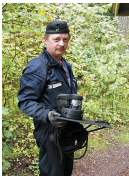
▲ En skorstensdammsugare är ett enkelt och effektivt verktyg ämnat för att hålla sotet och askan kvar i spisen när rökkanalerna sotas.
