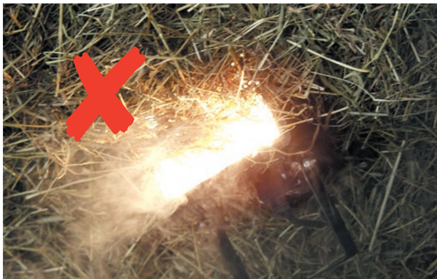
▼ En het halogenlampa antänder snabbt brandfarligt material som faller på lampan.
