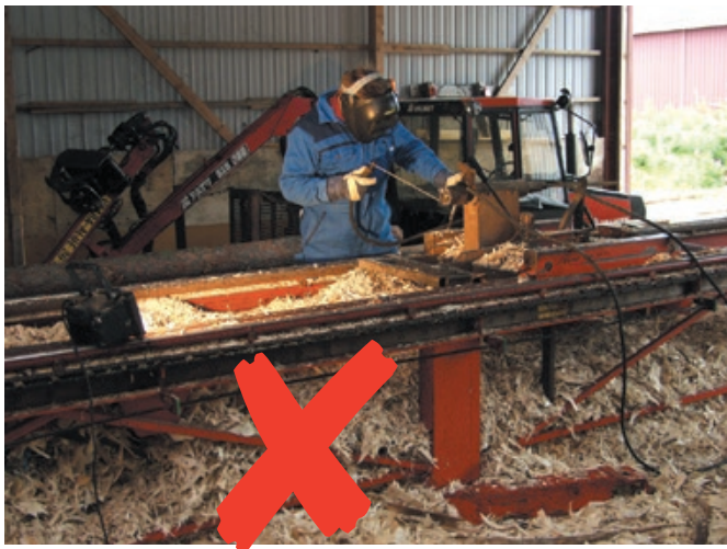
▲ Svetsning nära eller på brandfarligt material strider mot hetarbetsbestämmelserna. Här är brandrisken mycket hög.
